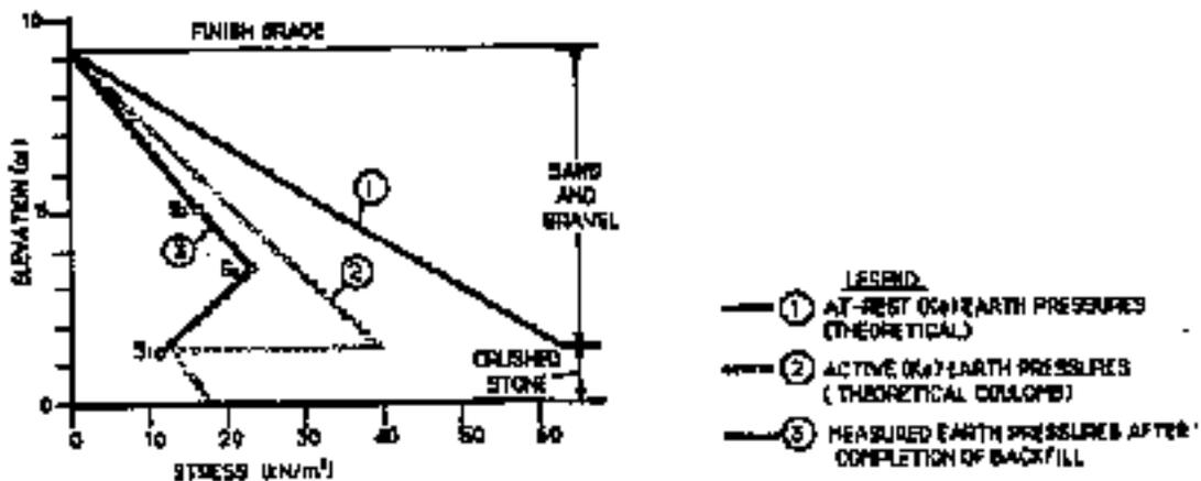
FIG 12 LATERAL PRESSURES AGAINST WALL AT FULL FILL HEIGHT
